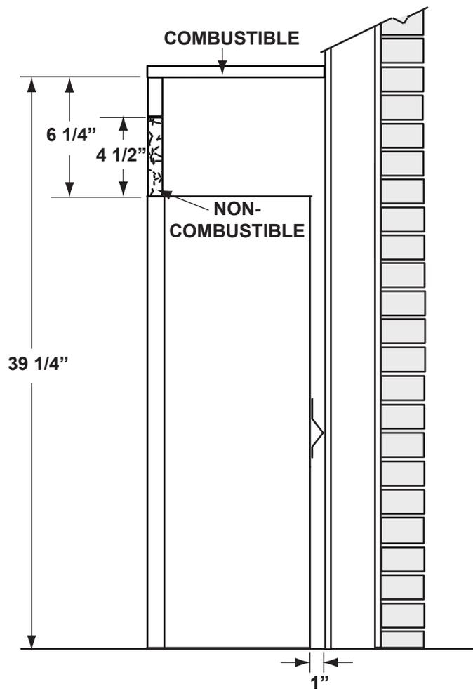
L'enceinte de l'appareil doit avoir une hauteur minimale de 39 1/4". Afin de respecter les contraintes de température, l'espace à l'intérieur de l'enceinte, autour de l'appareil et au-dessus, doit demeurer sans obstruction.
