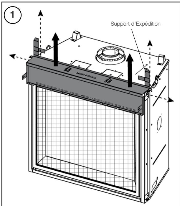
Retirez les 4 vis servant à fixer le bouclier d'espaceur. Retirez les supports d'expédition en les cassant ou en les repliant.
