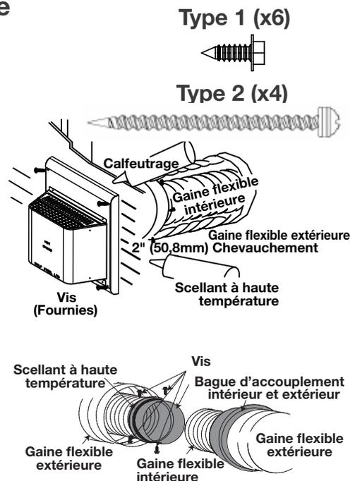
**Les terminaisons ne doivent pas être enchâssées dans un mur ou un revêtement extérieur plus que l'épaisseur de la bride de la plaque de montage.**
