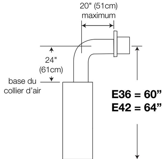
Utilisez l'ensemble périscopique afin de positionner la terminaison au-dessus du niveau du sol. L'ensemble périscopique doit être installé de façon à ce que la fente d'air du bas soit située à un minimum de 12 pouces (304,8mm) au-dessus du niveau du sol. La longueur maximale permise de l'évent (comprenant l'hauteur et la longueur) est 10 pieds (3,1m) pour les foyers et 8 pieds (2m) pour un poêle.
