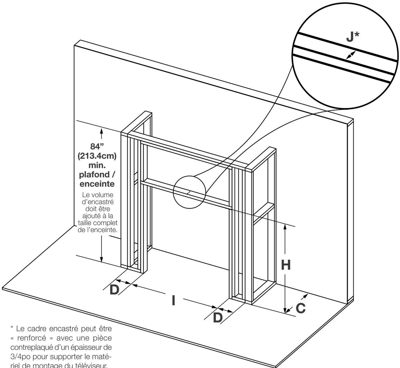
\* Le cadre encastré peut être « renforcé » avec une pièce contreplaqué d'un épaisseur de 3/4po pour supporter le matériel de montage du téléviseur.
