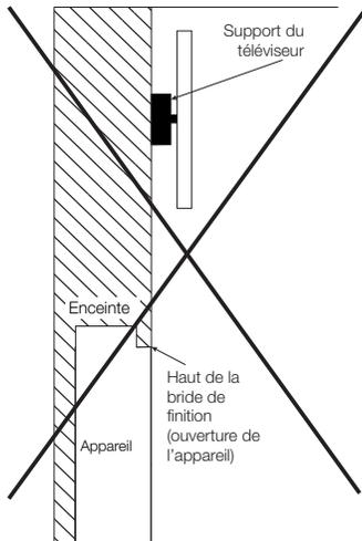
Installation partiellement enchâssées avec un manteau
