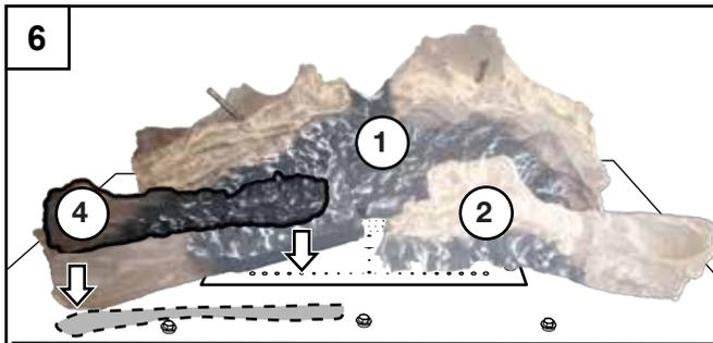
Placez bûche #4 (**W135-0688**) sur le côté avant gauche du plateau de support. Ne couvrez pas les orifices du brûleur.
