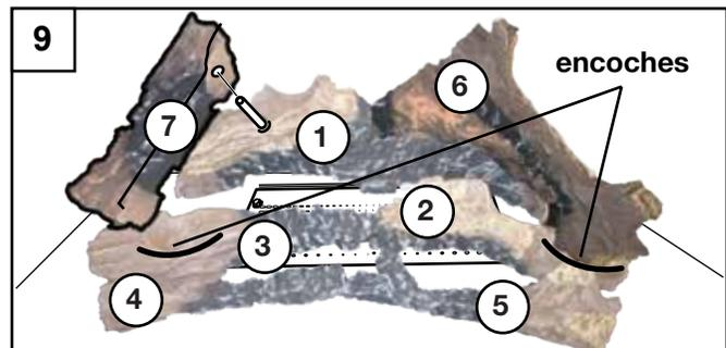
Restez l'autre extrémité de bûche #6 dans l'encoche de bûche #2. Placez le trou au fond de bûche #7 (**W135-0696**) sur l'épingle situé sur le côté gauche de bûche #1. Restez l'autre extrémité de bûche #7 sur l'encoche de bûche #3.
