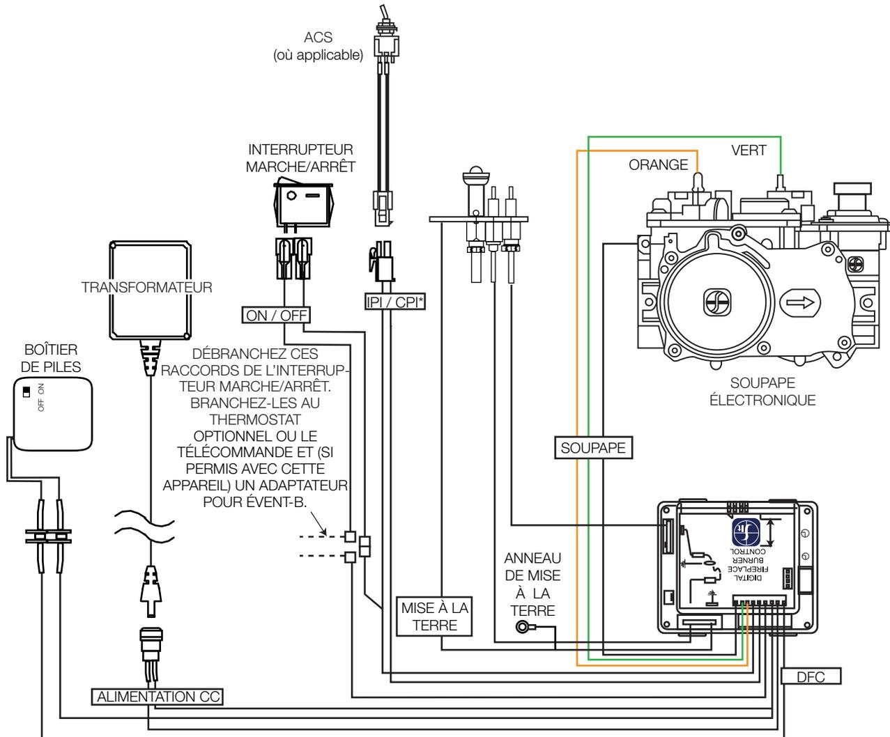
S'IL Y A LIEU, LES APPAREILS AVEC LES ADAPTATEURS POUR ÉVENT-B DOIVENT AVOIR L'INTERRUPTEUR D'ÉCOULEMENT BRANCHÉ EN SÉRIE AVEC L'INTERRUPTEUR ACTUEL OU L'INTERRUPTEUR MURAL OPTIONNEL, LE THERMOSTAT OU LE SYSTÈME DE TÉLÉCOMMANDE.
