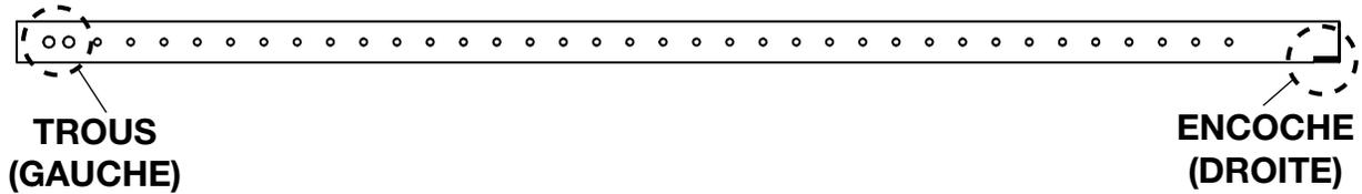
1. Avec la porte de l'appareil ouverte ou retirée, insérez le côté gauche du tube d'air secondaire dans le trou sur le **côté gauche** de l'appareil.
