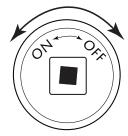
Fig. 8 Key Valve Face
